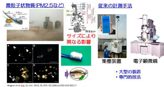
図 2. PM2.5 の現状と従来の計測手法。
